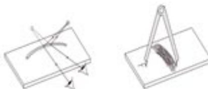
Grebanje glatke površine kružnim lukovima čiji centar se pomera duž odabranog simbola (slova F). Svaki kružni zarez se ponaša kao cilindrično ogledalo i formira imaginarni lik svetlosnog izvora.
